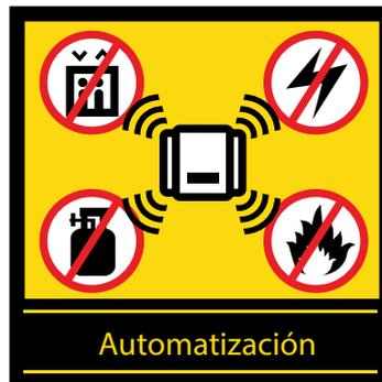
P-Alert puede integrarse con válvulas de gas, sistemas de potencia, elevadores y cualquier sistema de automatización y es capaz de apagarlos antes o durante un terremoto. Esto ayudaría a reducir los riesgos secundarios.
